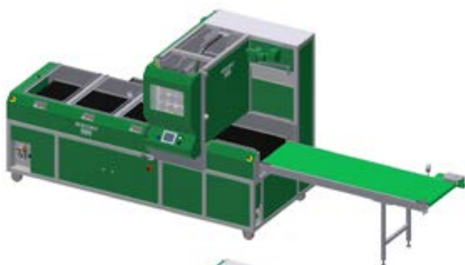
TYPE: B024 Pottemaskine med tilkoblet transportbånd.
