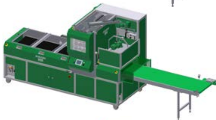
TYPE: B024D Pottemaskine med boreenhed og tilkoblet transportbånd.
